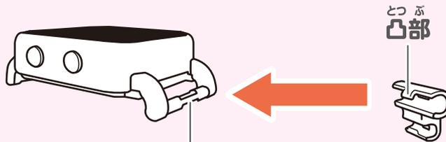
※軸の平らな部分に、ジョイントの凸部を合わせて取り付けます。
