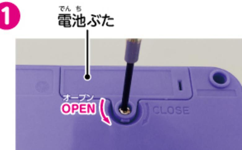
本体背面の電池ぶたをプラスまたはマイナスドライバーで矢印の方向にねじを回して開けてください。
