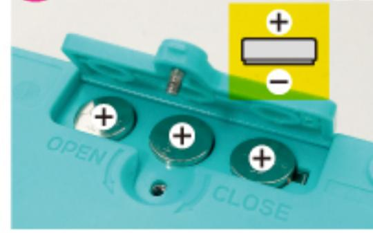
LR44ボタン電池3個を十一(プラスマイナス)を間違えないように図のように入れてください。セット後は電池ぶたのツメを本体の溝にさしこみながら閉じて、矢印の方向にねじを回してしめてください。
