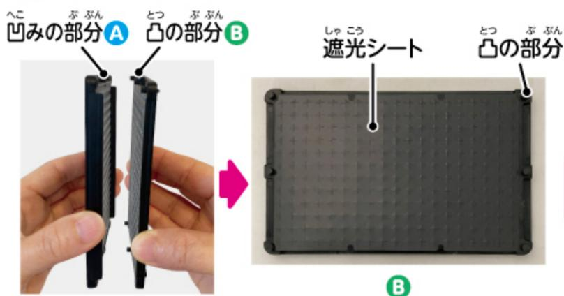
イルミカセットを開いて離します。凸の部分のあるイルミカセット(B)を上に向けて置き、遮光シートをセットします。
